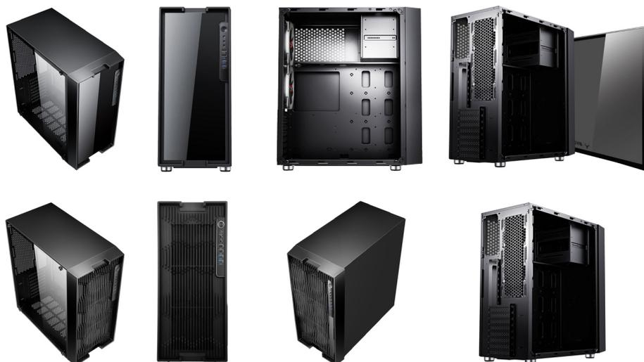
Nel case BYZON cattura l'attenzione la struttura di nuova generazione che colloca l'alimentatore, verticalmente, nella parte superiore del case. Questa soluzione permette di ottenere un comodo cable management, un ottimo air flow e un assemblaggio facile, veloce e ordinato. Un'altra particolarità è la possibilità di cambiare, grazie a quattro comode viti, il frontale. Byzon infatti ha in dotazione ben due differenti pannelli: uno
